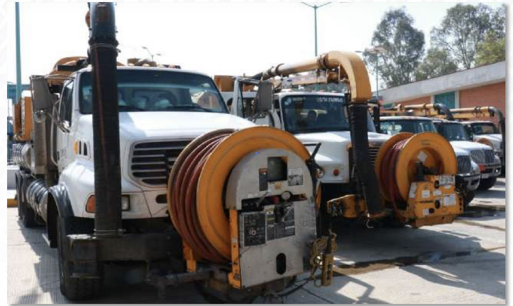
Equipo hidroneumático con capacidad para desalojar 7 m 3 de azolve
